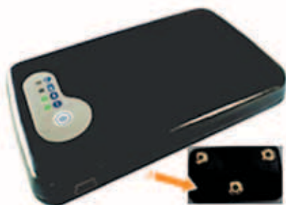
Figura 5A - Dispositivo de ECG com Eletrodos Ativos para ECG Wireless
